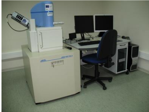
Fig. 12. Microscopio electrónico de barrido JEOL 6610LV empleado en los análisis.
