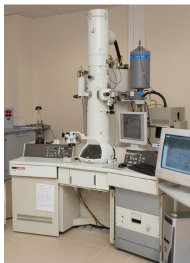
Fig. 13. Microscopio electrónico de transmisión JEOL-2000-EXII utilizado en los análisis.
