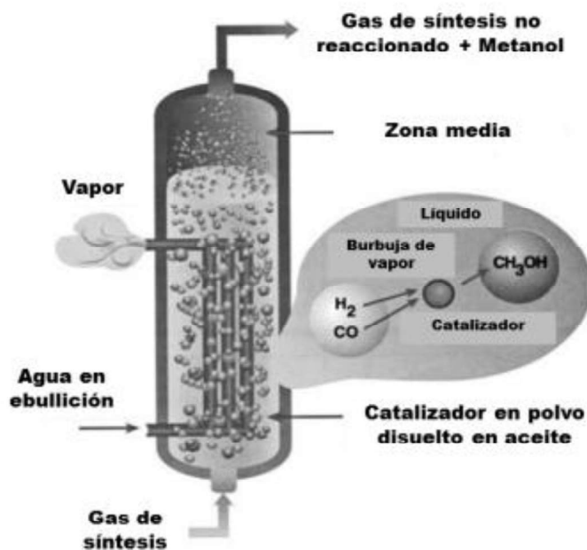
Figura [4]. Reactor tipo Lurgi convencional (CAÑETE, Benjamín et al... 2014).
