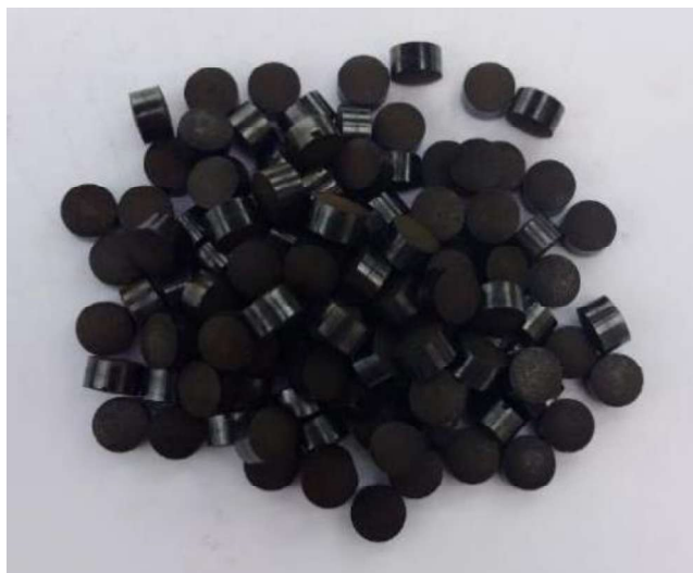
Figura [5]. Catalizador de metanol típico (Cu/ZnO/Al 2 O 3 ) en forma de gránulos (Ø4mm)
