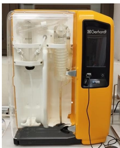
Figura 4.5. Equipo Gerhardt VAPODEST 500.
