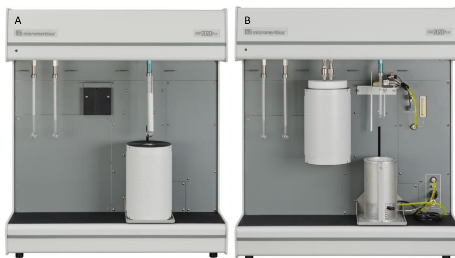
Figura 3.1. Equipos utilizados para la fisisorción de nitrógeno (A) y para la quimisorción de H_2 y CO (B). Micromeritics ASAP 2020
