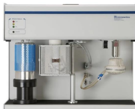
Figura 3.4. Equipo utilizado para la adsorción a temperatura programada. Autochem 2910 de Micromeritics
