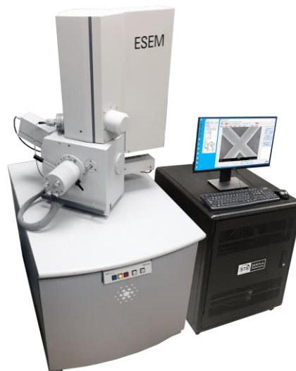
Figura 3.9. Microscopio electrónico de barrido FEI/Philips SXL30S FEG
