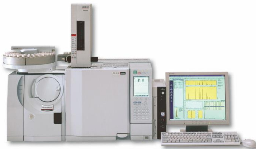
Figura 3.12. Cromatógrafo de gases empleado para identificación de compuestos. GC-MS QP2010 Plus Instrument.
