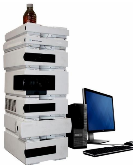
Figura 3.13. Cromatógrafo de líquidos empleado para la cuantificación de productos y reactivos Agilent 1200
