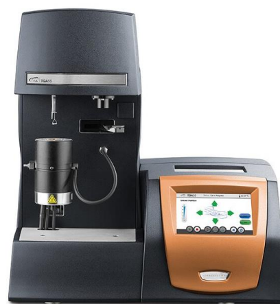
Figura 3.6. Equipo utilizado para los ensayos termogravimétricos (TGA 55)
