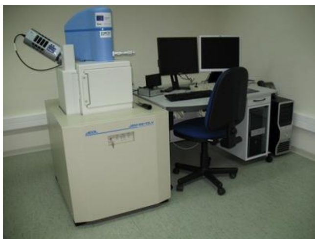
Figura 8. Equipo JEOL-6610LV Microscopio Electrónico de Barrido (Servicios Científico Técnicos de la Universidad de Oviedo, n.d.).
