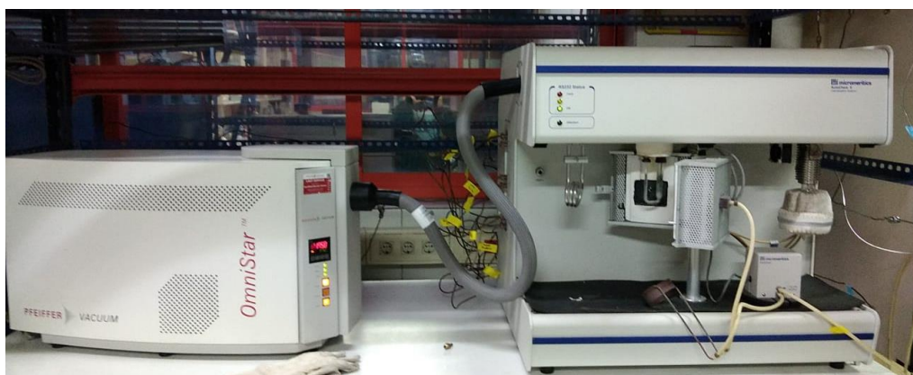
Fig. 25. Equipo para los ensayos a temperatura programada: Micromeritics AutoChem II 2920 acoplado a un espectrómetro de masas modelo Pfeiffer Vacuum Omnista
