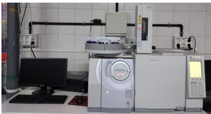
Fig. 21. Cromatografía de gases acoplada a una detección por espectrometría de masas, GC-MS Shimadzu QP 2010
