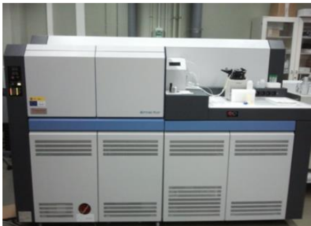
Fig. 17. Espectrometría de masas con fuente de plasma acoplado inductivamente, ICP-MS Neptune Plus , ThermoScientific
