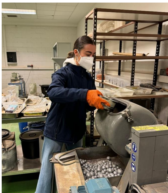
Figura 20. Vertiendo el material en el molino. Fuente:(Elaboración propia).
