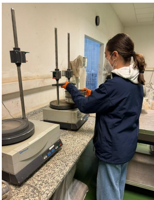
Figura 21. Colocando el material en la tamizadora. Fuente:(Elaboración propia).
