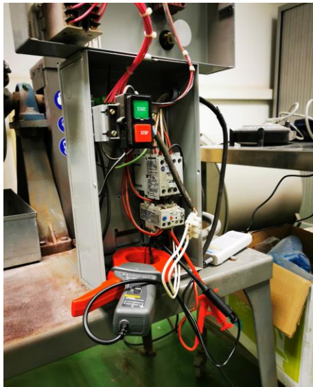
Figura 23. Conexión entre el osciloscopio y el molino de bolas. Fuente:(Elaboración propia).
