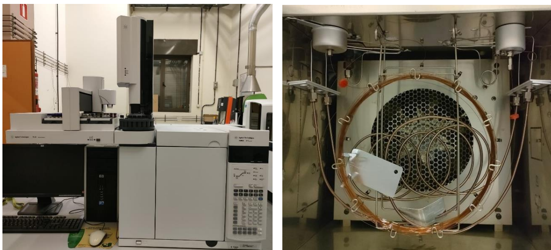
Figura 21. Columnas empacadas del interior del cromatógrafo e inyector para introducir la muestra
