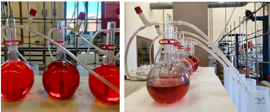
Figura 24. Sistema de desplazamiento para medir el volumen de biogás generado
