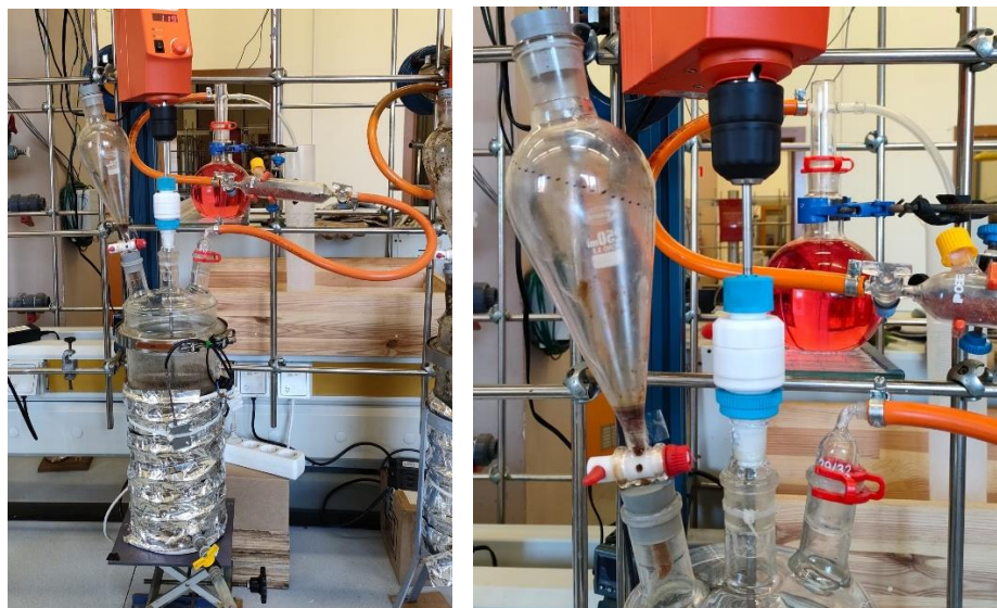
Figura 25. Reactor anaerobio de 5L conectado al sistema de desplazamiento
