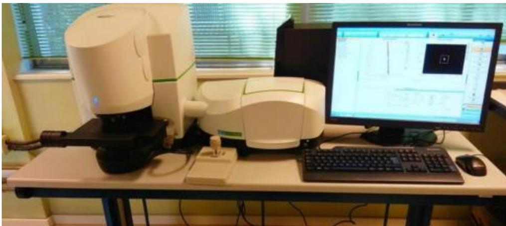
Figura 14. Espectrofotómetro FTIR Spotlight 200i de Perkin Elmer [134].
