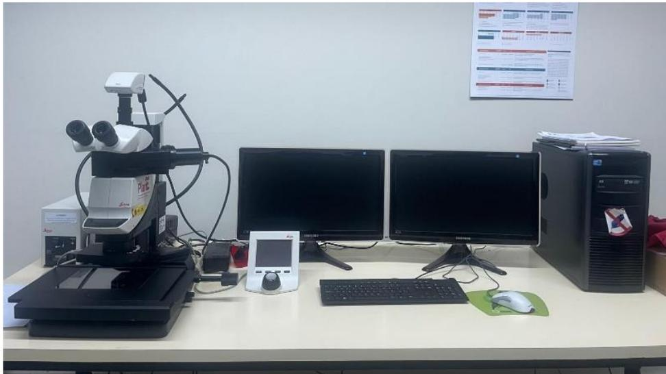
Figura 17. Estereomicroscopio Leica M205FA.
