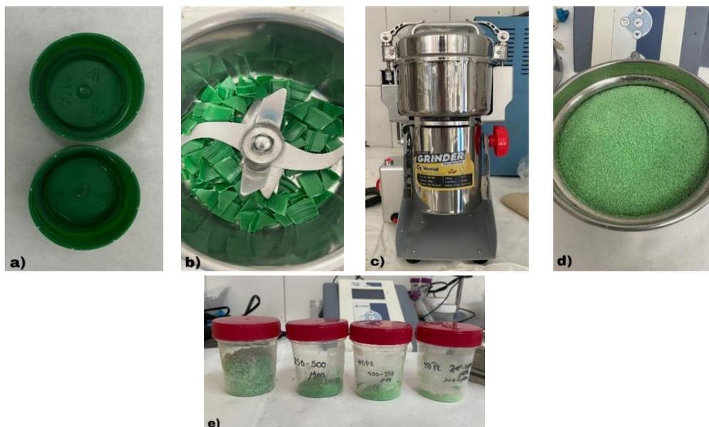
Figura 11. Proceso de preparación de los MPs de HDPE empleados como modelo en este trabajo: tapones sin tratar (a), tapones troceados dentro del triturador (b), triturador eléctrico (c), tamiz con la fracción de 100 – 250  $\mu\text{m}$  (d) y diferentes fracciones de MPs obtenidas (e).
