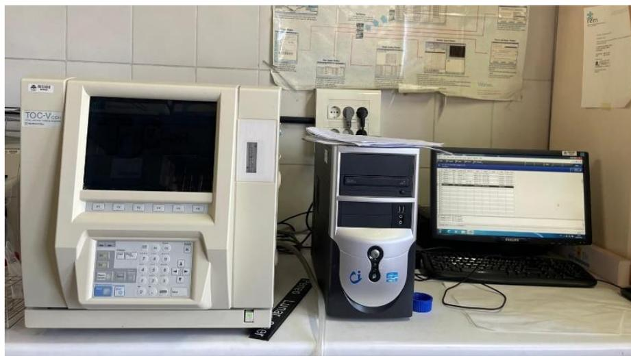
*Figura 15. Analizador TOC-V CSH.*
