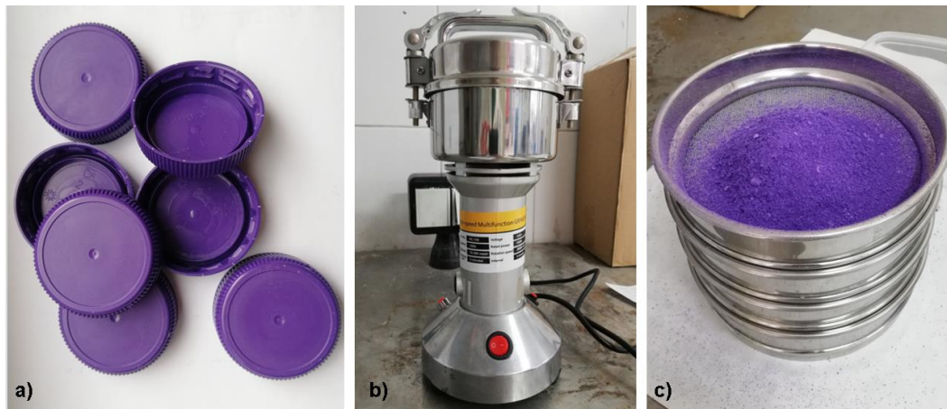
Figura 8: Material empleado para la obtención de los microplásticos empleados como modelo. Se muestran los tapones de HDPE procedentes de un envase alimentario (a), el molinillo empleado para su trituración (b) y los tamices de diferentes tamaños de malla para separar la fracción de MPs de 100-250 \mu\text{m} .
