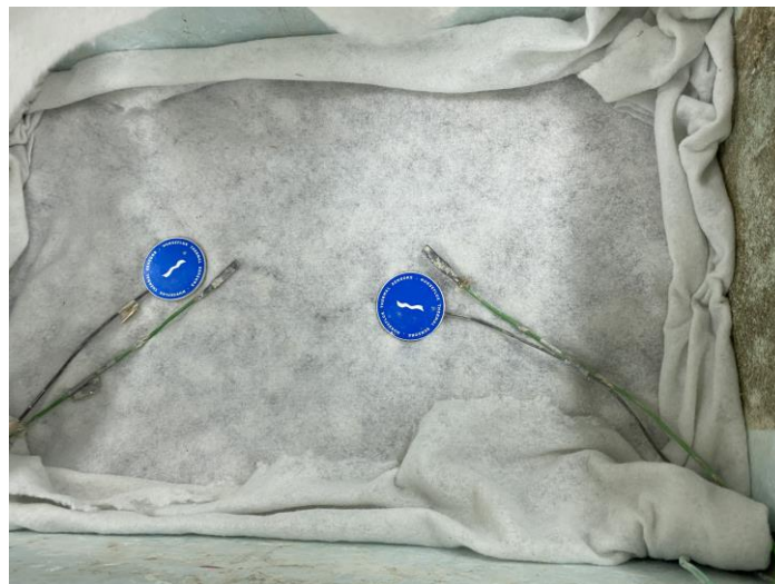
Figura 35. Parte superior de la segunda capa con los termopares y sensores de flujo térmico utilizados.
