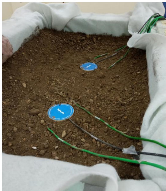
Figura 37. Disposición de los diferentes termopares y sensores de flujo térmico en la parte superior de la capa de tierra vegetal presente en las 3 cunetas ensayadas.
