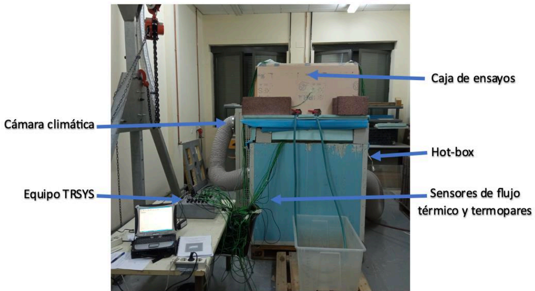
Figura 32. Montaje completo de los equipos utilizados.
