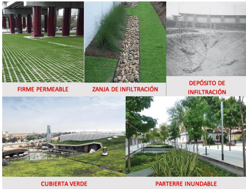
Figura 4. Sistemas de infiltración y control en origen.
