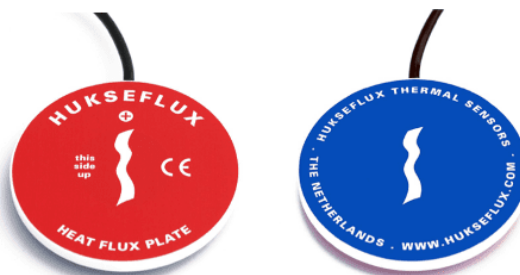
Figura 30. Sensor de flujo térmico por ambas caras: izquierda, en rojo, orientada a la fuente de calor y derecha, en azul, orientada en la cara opuesta a la fuente de calor.
