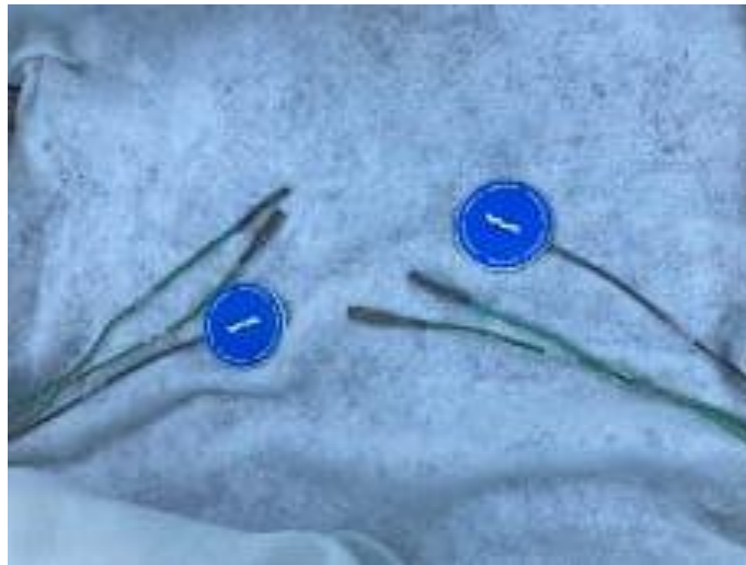
Figura 36. Parte superior de la tercera capa con los termopares y sensores de flujo térmico utilizados.
