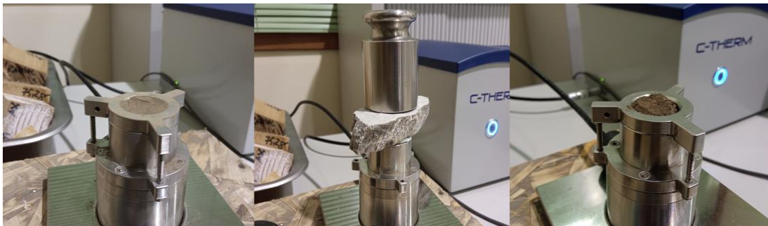
Figura 31. Medición con el equipo TCi del árido ligero (izquierda), árido calizo (centro) y tierra vegetal (derecha).
