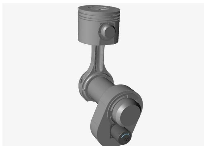
Figura 4.4 – Ensamblaje CAD cigüeñal - biela - pistón.
