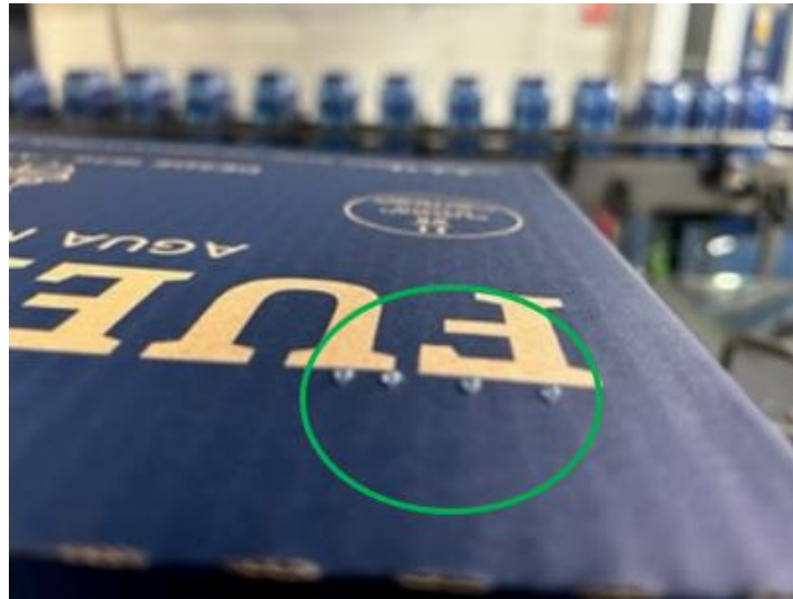
Figura 3.3: Utilización de cola antideslizante en cajas.
