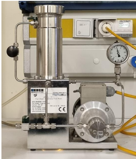
Figura 4.13. Equipo de filtración KSS Laboratory Cell CF – 2 de marca Koch.
