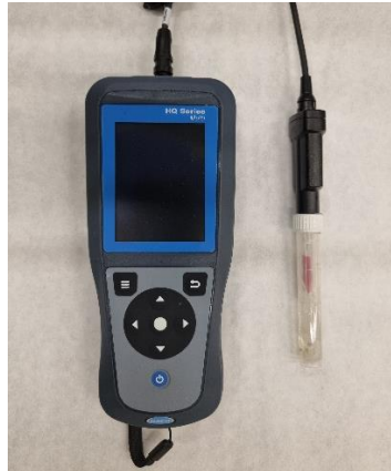
Figura 4.1. Multímetro Hach HQ4300 y sonda de pH PHC745.
