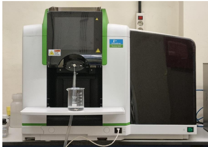
Figura 4.6. Espectrofotómetro de absorción atómica Perkim Elmer modelo PinAAcle 900F.
