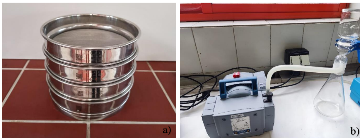
Figura 14. Material utilizado en el pretratamiento de la muestra. a) Tamices de distintos tamaños de poro: 500, 250, 100 y 20 \mu\text{m} , b) Equipo de filtración.
