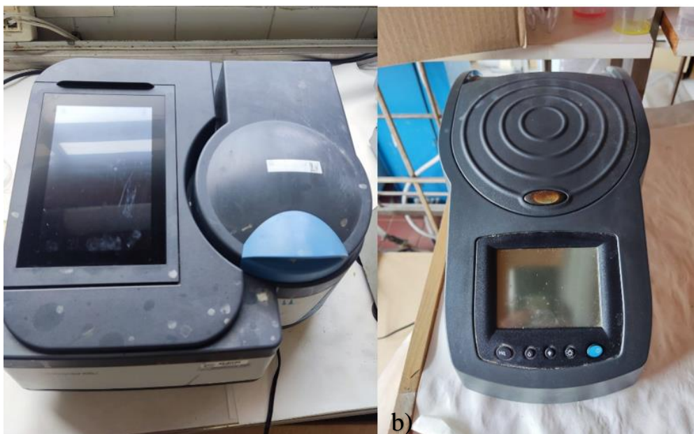
Figura 9. Espectrofotómetros empleados para la caracterización de la composición de las SPE; a) ácidos húmicos y proteínas; b) carbohidratos.
