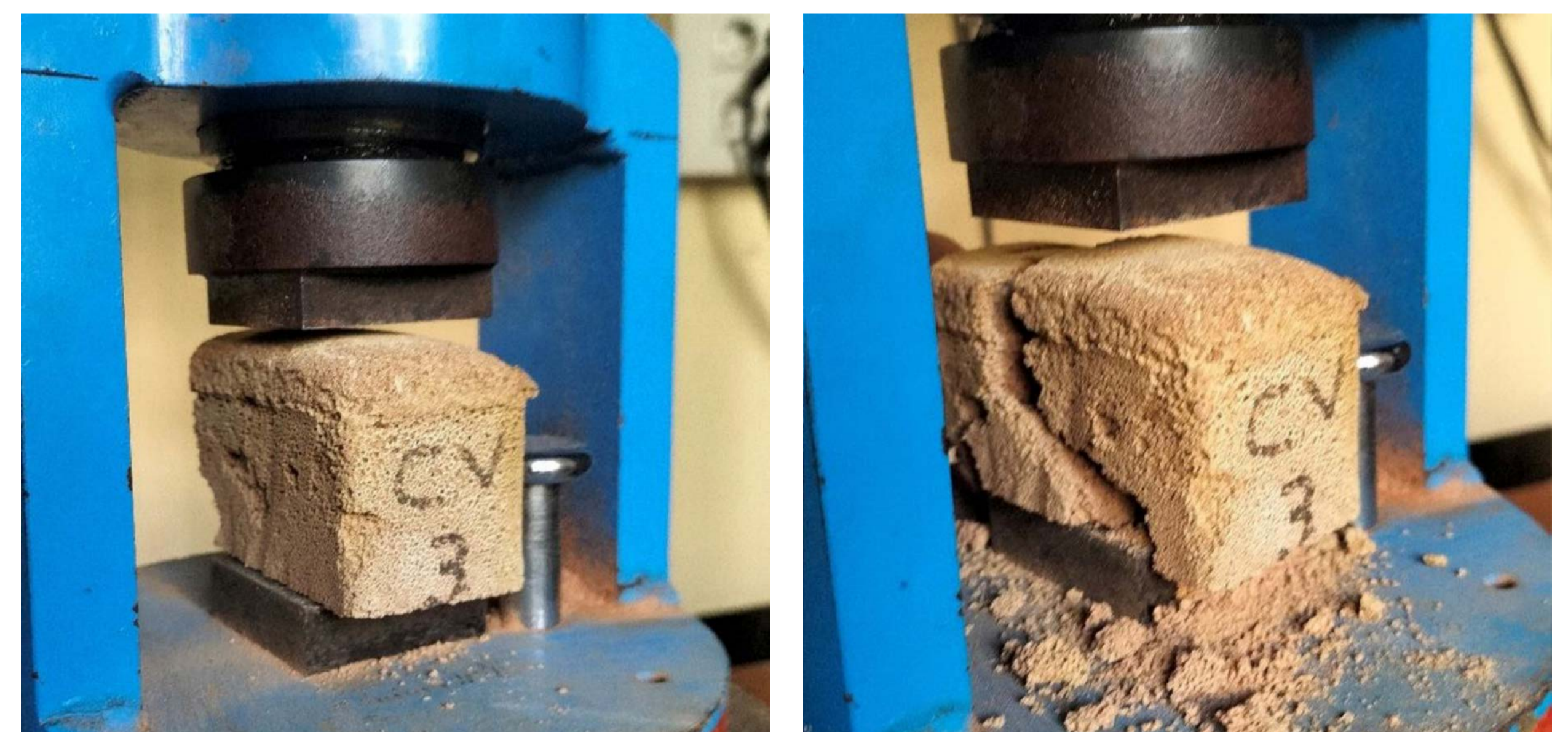
Ladrillo antes y después del ensayo de compresión
