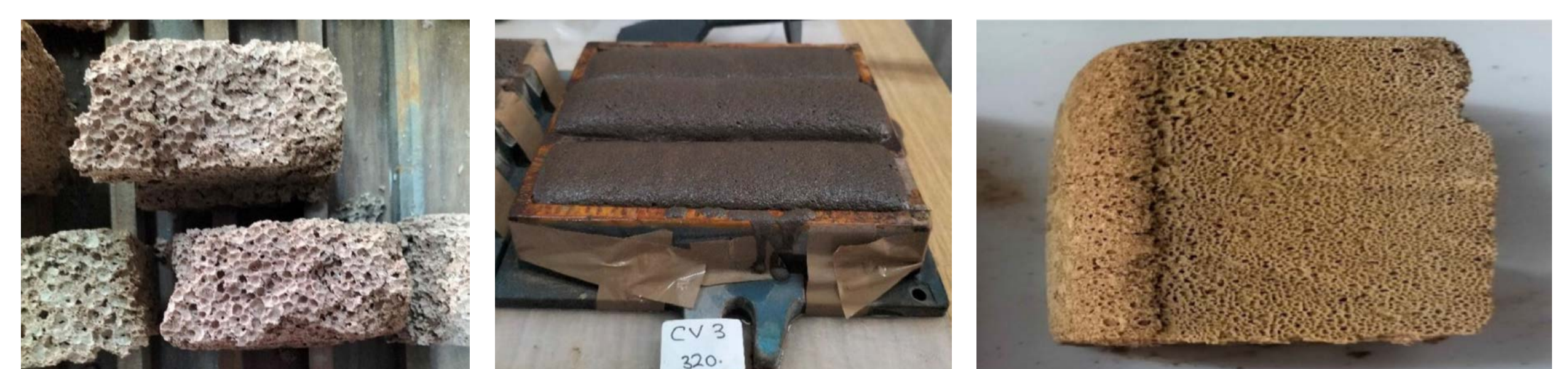
Comparación entre geopolímeros con diferentes porosidades
